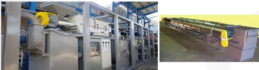
콘크리트 폐기물 처리장치
